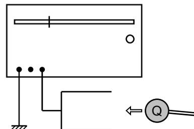
Beispiel 2: Die Ladung eines Körpers (Leiter oder Isolator) wird ermittelt, indem die gleich große Influenzladung eines über das DEM geerdeten Metallbeckers gemessen wird. Der Körper sollte vollständig in den Becher eintauchen, muss ihn aber nicht berühren.
