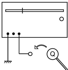
Beispiel 1: Die von einer Metallkugel als Stromstoß abfließende Ladung wird bestimmt. Es ist kein externer Vorwiderstand erforderlich. Für quantitative Messungen muss die Minusbuchse geerdet werden. Für qualitative Versuche genügt die "Erdung" durch das Holzgehäuse.
