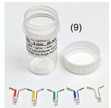
Bei diesem Spektrometer wird die hohe Intensität und die kleine Leuchtfläche moderner 3mm-LEDs genutzt, um ohne Spalt ein Spektrum abzubilden, das bei leicht reduziertem Raumlicht gut erkennbar ist. Die Komponenten (LED-Halter, Blende, Rahmenhalter und Schirm) besitzen Führungsnuten und werden mit Hilfe einer auf dem Tisch liegenden 12mm-Stativstange ausgerichtet (nicht im Lieferumfang), so dass keine optische Bank erforderlich ist.
